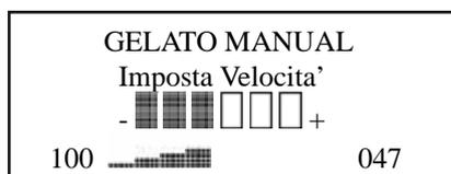
La velocità proposta inizialmente è sempre la velocità standard di mantecazione, ma è possibile variarla con i tasti Incremento e Decremento.
